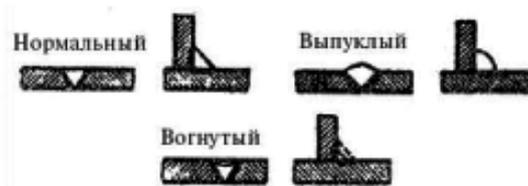
Рис. 26. Классификация сварных швов по форме наружной поверхности
