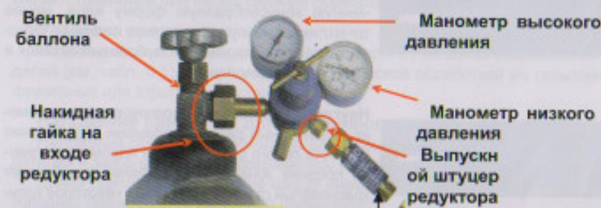
Рис.5.3. – Присоединение редуктора.
