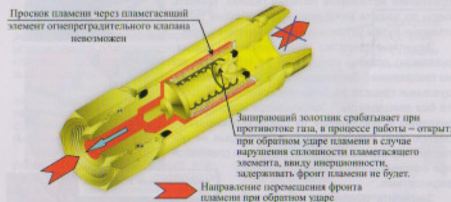
Рис.3.8.2. Состояние огнепреградительного клапана при возникновении обратного удара со стороны резака (горелки).
