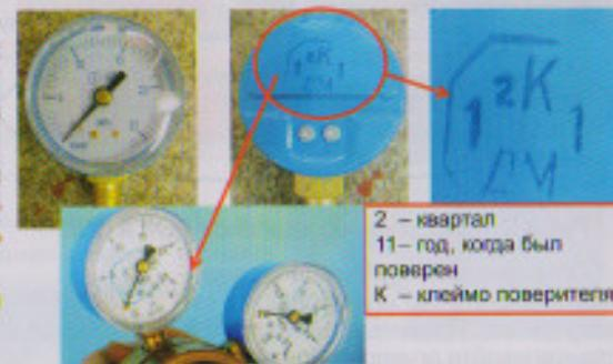
Рис.4.5. - Дата поверки манометров
