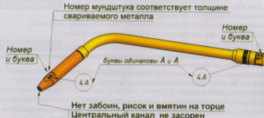
Рис. 5.1. – Наконечник горелки
