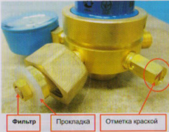
Рис.4.4. – Внешний осмотр редуктора.
