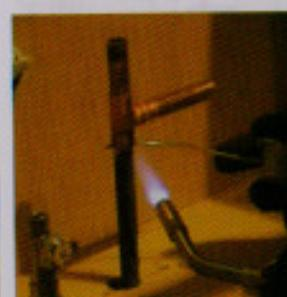
**4. Пайка** – называется процесс получения неразъемного соединения металлических деталей, находящихся в твёрдом состоянии, при помощи расплавленного присадочного металла или сплава (припоя). При пайке в отличие от сварки расплавляется только припой, а основной металл нагревается до температуры, несколько выше температуры плавления припоя.
