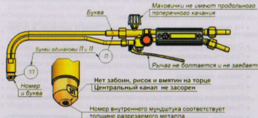
Рис.5.14. – Осмотр резака на примере Р1 "ДОНМЕТ" 150П
